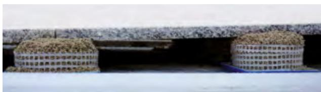
Anneaux spéciaux pour égaliser les hauteurs servant de coffrage pour le mortier. Ces anneaux de compensation de 27 mm ou 50 mm de haut s'empilent sans problème. Il est ainsi possible de compenser des hauteurs allant jusqu'à 150 mm. Il est ainsi possible de régler simplement les pentes de revêtement. (Voir les vidéos TechnikTipps dans la vidéothèque GUTJAHR)
