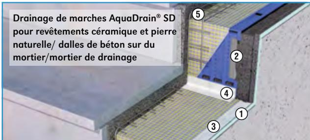
Drainage de marches Aqua Drain® SD pour revêtements céramique et pierre naturelle/ dalles de béton sur du mortier/mortier de drainage
