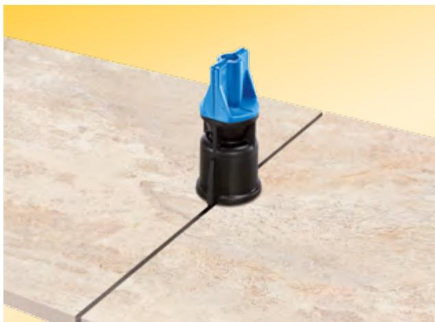
Le système de nivellement IndorTec® FN aligne avec précision les carreaux et les dalles, même de grands formats. Les irrégularités causées par les décalages en hauteur appartiennent au passé. L'utilisation est très facile en seulement 3 étapes : poser, bloquer, fixer par rotation. IndorTec® FN s'ancre dans le joint ouvert et ne génère donc aucune rayure ou marque sur la surface du revêtement.
