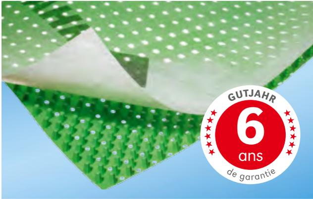
L'AquaDrain® HU est un drainage de surface anti-remontée d'humidité très résistant, développé pour la pose flottante sur des supports non adhérent et adhérent. Contrairement aux membranes d'étanchéité en polyéthylène rigide conventionnelles, l'AquaDrain® HU est troué sur la face inférieure : l'eau d'infiltration peut donc également s'écouler de manière ciblée sur des supports non plats.
