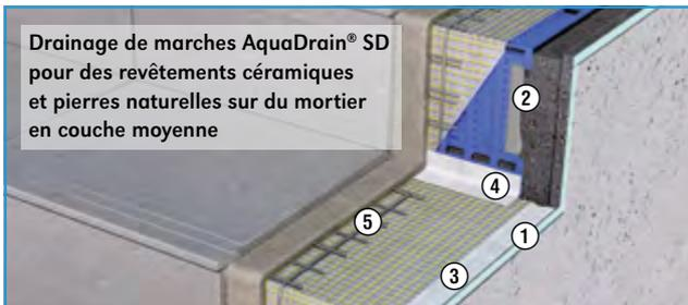
Drainage de marches Aqua Drain® SD pour des revêtements céramiques et pierres naturelles sur du mortier en couche moyenne
