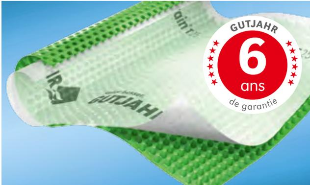
Il arrive très fréquemment que les (toitures)-terrasses présentent une pente faible voire nulle sur l'étanchéité. L'eau stagne sur une grande surface sur l'étanchéité et l'écoulement est fortement retardé. Aqua Drain® T25 présente une épaisseur de 25 mm. Cela évite la pression hydrostatique et ainsi les dégâts sur l'étanchéité. Le non-tissé spécial laminé surélève le revêtement sur toute la surface et empêche l'humidité stagnante de retourner dans la construction.
