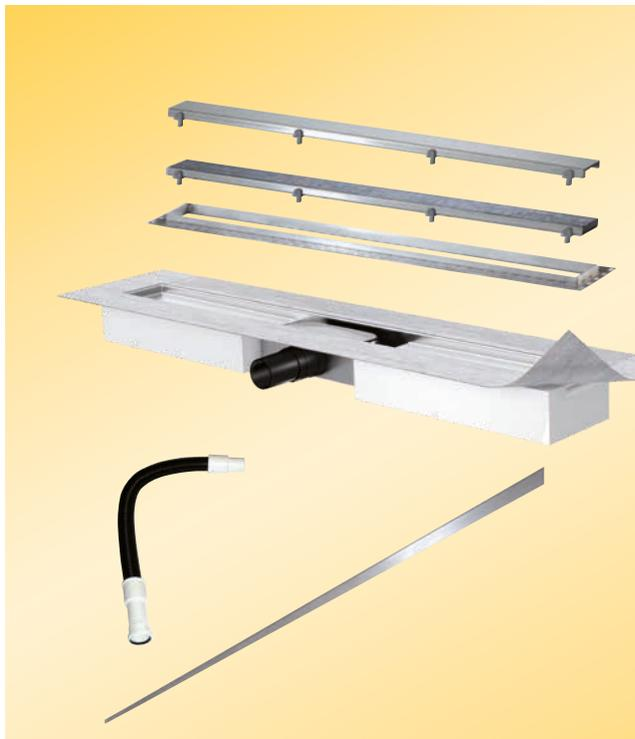
L'IndorTec® FLEXDRAIN est un système de rainure d'écoulement de douche innovant très plat doté d'un deuxième niveau de drainage unique. Ainsi, l'eau infiltrée dans les joints par le biais de la construction est évacuée de manière fiable dans la rainure d'écoulement de douche, empêchant ainsi des dégâts dus à l'eau stagnante.
