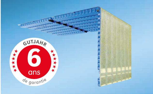
Les drainages de marches Aqua Drain® SD protègent de manière fiable les escaliers extérieurs revêtus de carreaux céramiques ou pierres naturelles/dalles de béton des efflorescences de chaux et des dégâts dus au gel provoqués par l'eau stagnante. Ils peuvent être utilisés comme drainage dans un lit de mortier moyen ou sur du mortier de drainage ou sur des bandes de mortier aux marches-blocs resp. sur du mortier de drainage combiné.
