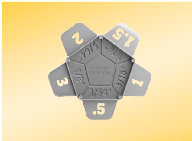
L'entretoise de joint IndorTec® FA est l'assurance d'un aspect uniforme des joints pour les carrelages calibrés et rectifiés ainsi que pour la pierre naturelle. Des joints de 0,5 à 3 mm de largeur sont possibles. Des joints jusqu'à 6 mm de largeur sont possibles en combinaison avec deux entretoises de joint. La gradation de 0,5 mm de l'entretoise de joint garantit un jointoiement régulier.
