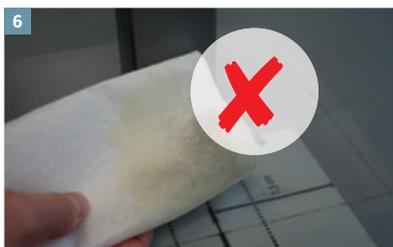
Der Reinigungsvorgang mit DiProtec® PR-MT ist zu wiederholen bis das Tuch keine Rückstände mehr aufweist.
