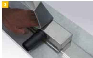
3 Falls notwendig, kann der Rinnenträger entfernt und das Butylband unterseitig an den Rinnenkörper geklebt werden.
