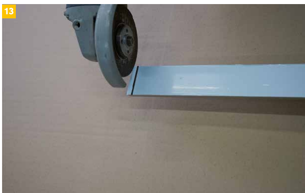
13 ...und auf die erforderliche Länge kürzen (abschneiden).
