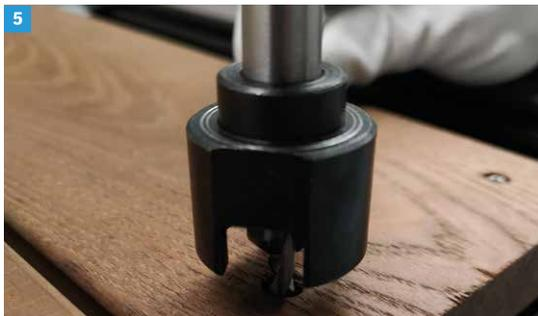
5 Alternativ Vorbohren mit **TerraMaxx® RS** Senkbohrer hierbei können die Schraubköpfe versenkt werden.
