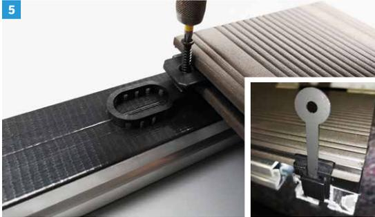
Befestigung **TerraMaxx® RS-NK** Dielenfix durch leichtes Anziehen der Schraube. Muss die Verbindung nochmals gelöst werden, kann die Rastung mit dem beiliegenden Schlüssel wieder geöffnet werden.
