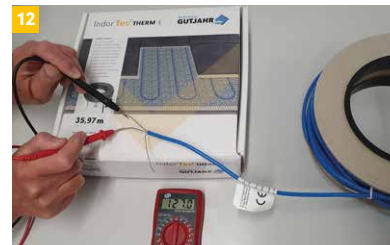
12 Vor Installation des Heizkabels und des Bodenfühlers ist der Gesamtwiderstand gemäß Abnahmeprotokoll zu überprüfen und zu protokollieren.
