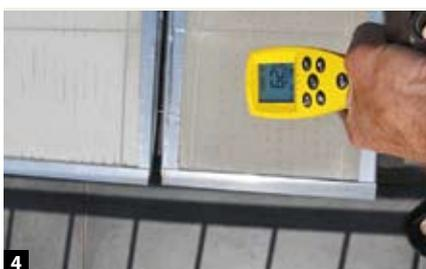
4 Der Belag der Versuchsfläche 3 (Serie B) mit dem höchsten Feuchtigkeitsanteil wurde am 10.07.2010 gegen 15 Uhr bis auf 62,5 °C erwärmt. Der trockenere hellere Belag hatte zur gleichen Zeit eine Oberflächentemperatur von 52,1 °C.
