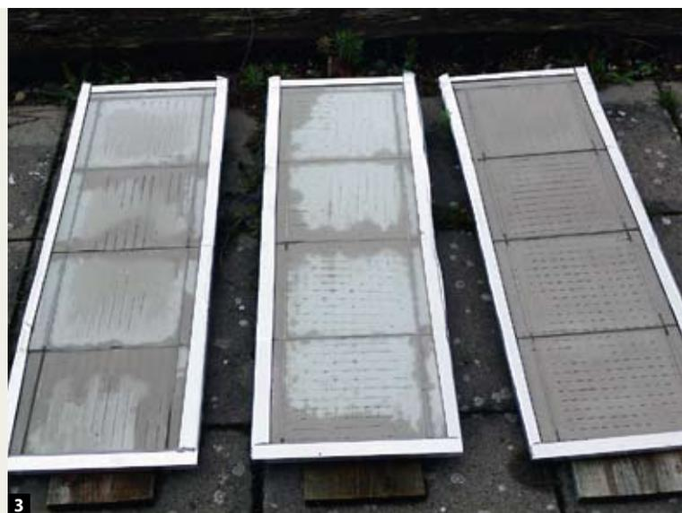
**1** Der erste Regen fiel 14 Tage nach Herstellung des Belags. Es ist zu erkennen, dass Wasser über die Fugen in den Klebemörtel gelangt ist, ebenso über den zu diesem Zeitpunkt noch offenen Rand (tiefer liegend unten).
