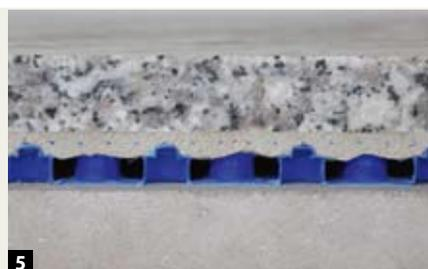
5 Bei Versuchsfläche 2 wird der Belag mit Klebemörtel sechs Millimeter kapillarpassiv aufgestellt. Kondensatbedingte Wassertropfen und bis vier Millimeter hohe Pfützen in der Drainage bleiben ohne Konsequenzen für den Mörtel. Dieser kann über die Luftschicht schneller trocknen.
