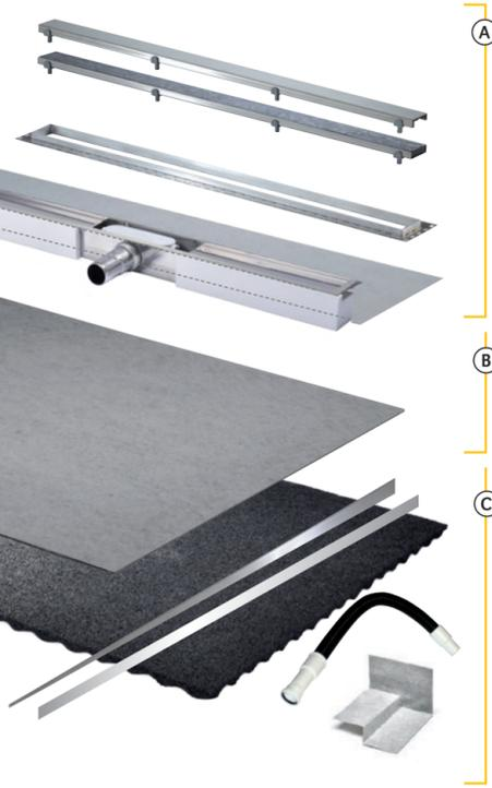
**Basissystem** bestehend aus Edelstahl-Rinnenkörper, mit Geruchsverschluss, Dichtmanschette, Drainrahmen und Wendeauflage. Komplett einbaufertig vormontiert mit integriertem Fixbaudapter. Alle Metallteile aus Edelstahl.
