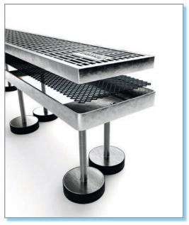
Weiterer Vorteil von AquaDrain DR-HB: Der Drainrost hat Drehfüße. Damit ist er zwischen 59 und 280 mm höhenverstellbar – und lässt sich so präzise auf Belagsniveau ausrichten. Ein integriertes Schmutzgitter verhindert Versottung. Die Rostauflage lässt sich mit dem integrierten Rostverschluss sichern und ist zur Revision einfach herausnehmbar.
