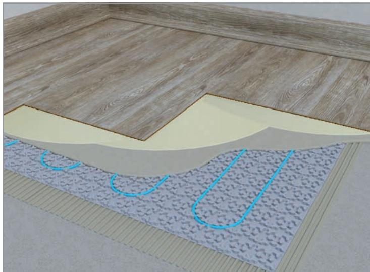
Beim Energiesparen hilft zudem, dass die elektrische Fußbodenheizung von Gutjahr die Wärme schnell auf den Bodenbelag überträgt. Der Grund dafür ist der dünnsschichtige Aufbau und die Spezialgeometrie der Matte.
