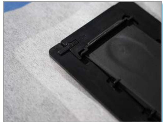
Die neue Estrichabziehlehre der Gutjahr-Duschrinne ermöglicht ein einfaches, flächenbündiges Abziehen des Estrichs. Der wichtigste Unterschied zu anderen Produkten: Sie ist direkt am Grundkörper montiert und wird auch nach dem Abziehen des Estrichs nicht entfernt. Deshalb muss auch die Dichtmanschette nicht zusammengefaltet werden. Stattdessen liegt sie sofort plan. Das vereinfacht die Einbettung des Vlieses in die Abdichtung.
