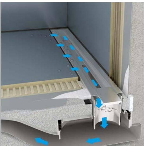
Normalerweise werden Estrichlehren nach dem Einbau des Estrichs entfernt. Dadurch entsteht eine kleine Vertiefung, die nachgearbeitet werden muss. Nicht so bei der Gutjahr-Estrichlehre: Sie bleibt an Ort und Stelle. Das macht die Ausführung der Duschrinne einfacher und schneller. Die Estrichabziehkante kann auf drei Seiten (für den Einbau an der Wand) oder umlaufend (für den Einbau in der Mitte) eingesetzt werden.
