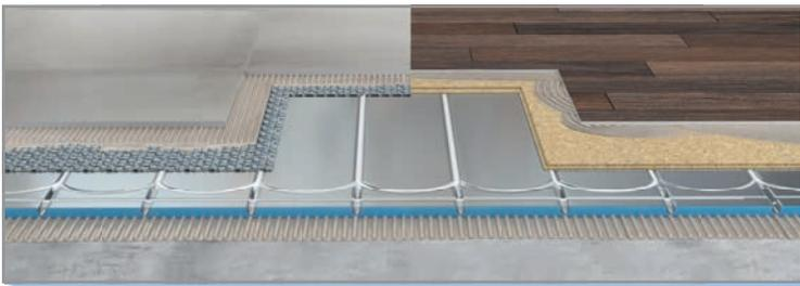
Gutjahr selbst hat inzwischen zwei Fußbodenheizungssysteme im Programm: Die Warmwasser-Fußbodenheizung IndorTec THERM-W und die Elektro-Flächenheizung IndorTec THERM-E. Bei der Entwicklung der Systeme hatte Gutjahr vor allem den Sanierungsmarkt im Blick, weil hier oft viele Faktoren vorgegeben sind und sich die Fußbodenheizung anpassen muss.
