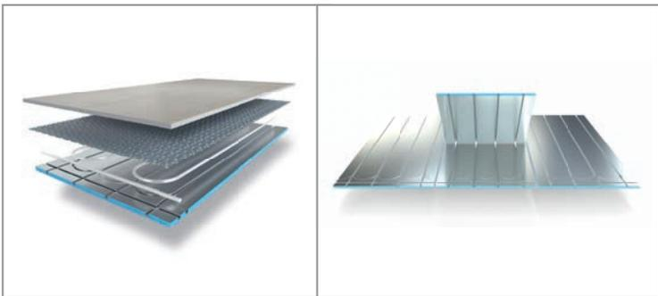
Einer dieser typischen Faktoren ist die Aufbauhöhe – die gerade in Altbauten oft fehlt. Deshalb sind die Gutjahr-Fußbodenheizungen besonders dünn. IndorTec THERM-W hat ein Trockenbau-System als Basis. Die Kabel von IndorTec THERM-E werden in eine Entkopplungsmatte eingeklippt, die zugleich als Abdichtung dient. Beide kommen ohne zusätzlichen Estrich aus.
