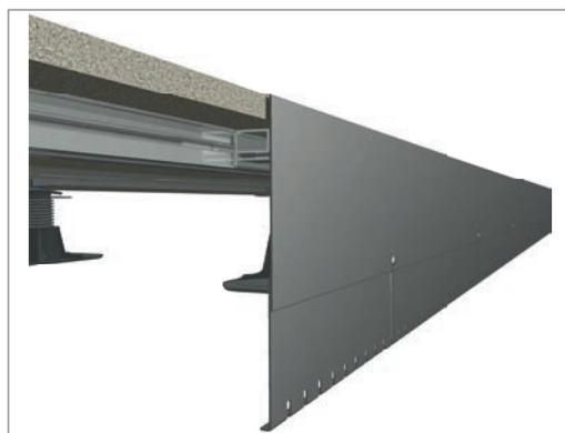
**ProFin RS** und **ProFin RS-H** sind klassische Randprofile aus pulverbeschichtetem Aluminium, die direkt am Alu-Rahmensystem befestigt werden. ProFin RS hat eine feste Höhe von 170 mm, ProFin RS-H hat zusätzlich eine höhen- und neigungsverstellbare Verlängerungsblende. Dadurch ist dieses Profil ideal für keilförmige Randbereiche geeignet, bei denen das Oberflächengefälle nicht dem Abdichtungsgefälle entspricht.
