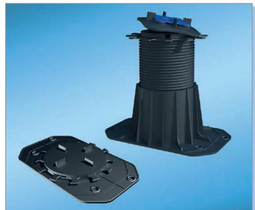
Mit dem Trocken-Stelzlager TerraMaxx TSL hat Gutjahr ein besonders flexibles Produkt für aufgestellte Beläge auf dem Markt etabliert: Es ist komplett vormontiert, ohne Werkzeug höhenverstellbar und nivellierfähig. Jetzt bekommt das Stelzlager-Sortiment Zuwachs: TerraMaxx TSL-R ist extrem flach – aber trotzdem höhenverstellbar. Das neue Trocken-Stelzlager deckt so die Bereiche zwischen 14 und 24 mm ab. Durch den freidrehenden Kopf lässt sich die Höhe auch nachträglich verstellen.
