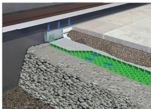
Mit der Gutjahr-Schlitzrinne können Außenbeläge effektiv, aber besonders dezent entwässert werden – auch bei niedrigen Aufbauhöhen. Jetzt hat Gutjahr das System vereinfacht. Statt also zwei verschiedene Schlitzrinnen für die Linienentwässerung und die Wandentwässerung gibt es mit AquaDrain SR-U jetzt ein universelles Produkt. Es ersetzt die bisherigen Schlitzrinnen AquaDrain SR-L und AquaDrain SR-W.
