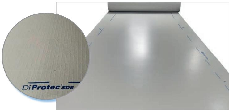
Die Schnelldichtbahn aus hochreißfestem Kunststoff wird ohne aufwendige Vorbereitung lose auf dem Untergrund verlegt. Das spart bei der Abdichtung von Balkonen und Terrassen bis zu 80 Prozent Zeit im Vergleich zu mineralischen Dichtschlämmen oder Flüssigabdichtungen. Noch etwas schneller ist die künftig verfügbare optimierte Variante von DiProtec SDB: Sie hat eine neue Oberflächenstruktur. Diese Prägung kann als Markierung für den Zuschnitt genutzt werden.
