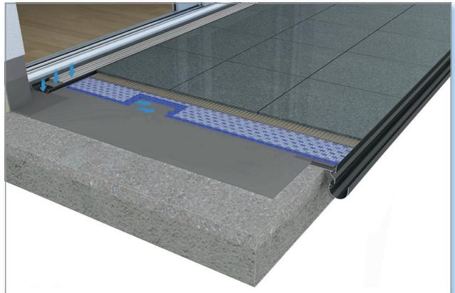
Das Wetter ist oft unberechenbar. Deshalb ist der Zeitdruck bei Arbeiten auf Balkonen und Terrassen besonders groß. Abhilfe schaffen drei schnelle Komplettsysteme von Gutjahr – für jeden Einsatzbereich das passende. Das erste Schnellbausystem besteht aus der Schnelldichtbahn DiProtec SDB und der kapillarpassiven Dünnschicht-drainage WatecDrain KP+. Das System reduziert die Verlegezeit um bis zu 80 Prozent – dank des dünn-schichtigen Aufbaus ab 21 mm inklusive Belag.
