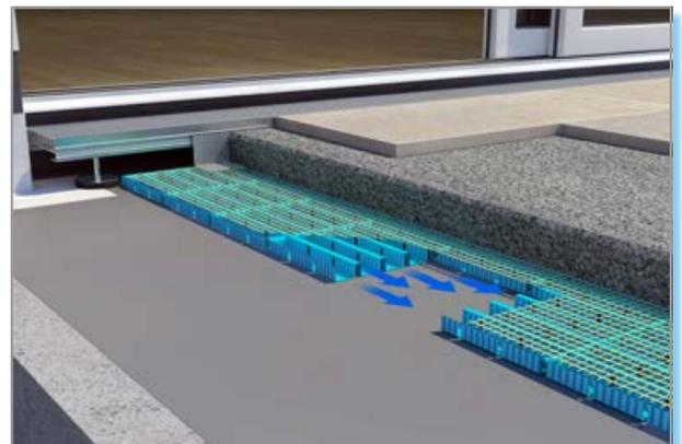
AquaDrain EK ist eine kapillarbrechende Flächendrainage für die Verlegung von Außenbelägen auf Drainmörtel. Sie stellt den Belag komplett auf. So bilden die Drainkanäle einen definierten Hohlraum von über 90 Prozent.
