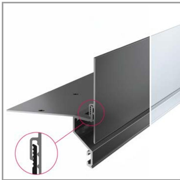
Das Profil-Baukastensystem bietet maximale Sicherheit. Dank der ungestanzten Schenkel in Kombination mit den selbstklebenden Systemdichtbändern können Abdichtungen einfach und sicher an die Profile angeschlossen werden. Zusätzlich verhindert die verdeckte Entwässerung, dass Schmutzwasser unkontrolliert durch stirnseitige Bohrlöcher abläuft und Schmutzfahnen an der Fassade verursacht.
