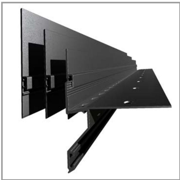
Insgesamt deckt das Gutjahr-Baukastensystem 32 verschiedene Aufbauhöhen zwischen 11 und 94 mm ab. Die beiden ProFin DP Basisprofile haben dabei eine Aufkantungshöhe von 11 und 21 mm. Sie können entweder allein verwendet oder durch die drei ProFin BL-R Rasterblenden erweitert werden – und zwar in vier Rasterstufen à 2 mm. Das macht die Verarbeitung einfach und sicher.
