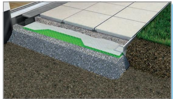
Mit der Optimierung des Dichtbands beweist der Entwässerungsspezialist einmal mehr, wie wichtig ihm Details sind. Doch es ist nur ein Produkt von vielen, die Gutjahr immer wieder hinterfragt und „neu denkt“. Ein Beispiel ist das Fugenkreuz: Statt eines kompletten Bodens verfügt AquaDrain FF jetzt zudem über einen offenen Viertelkreisbogen, der das Hocharbeiten über die Kanten verhindert.
