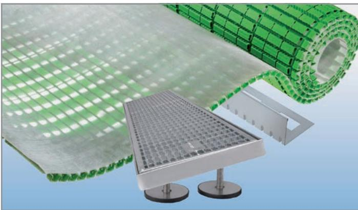
Eine praktische und sichere Lösung ist das Komplettsystem mit dem Spezialdrainrost AquaDrain BF-Flex plus passende Flächendrainage. Anders als Kastenrinnen ist er nach unten offen und sorgt so für die rückstaufreie Entwässerung im Türanschlussbereich, wie es die wichtigen Normen vorsehen. Der Clou: Der Rost lässt sich schräg – also als Rampe – vor bodentiefen Türen oder Fenstern einbauen.
