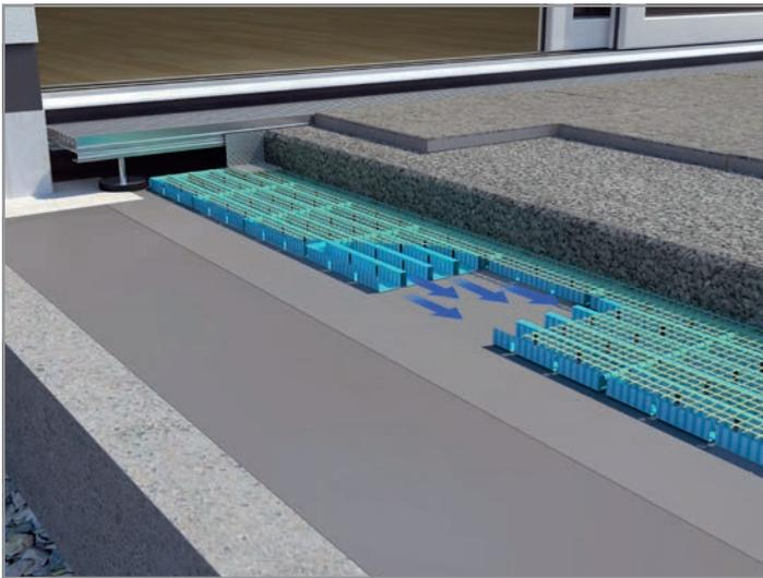
Das gilt auch für die Übergänge auf Balkonen und Terrassen. Allerdings sind hier die technischen Herausforderungen groß. Besonders wichtig ist DIN 18531: Sie erlaubt deutlich geringere Türanschlusshöhen – vorausgesetzt, die dauerhafte Entwässerung des anfallenden Wassers im Türbereich ist sichergestellt.
