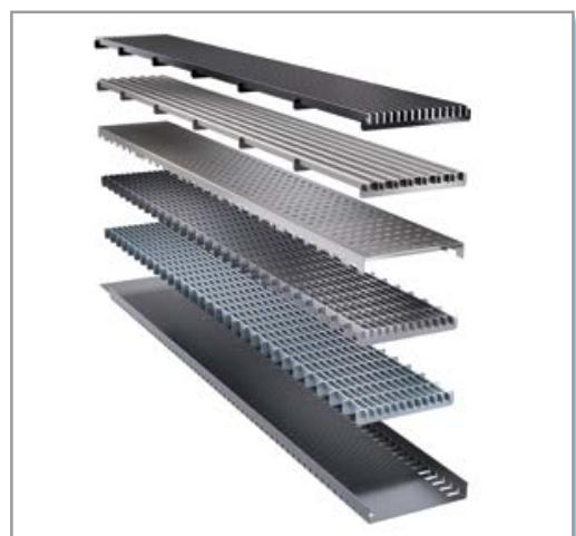
Gutjahr setzt bei AquaDrain VARIO+ auf ein langlebiges Konzept: Der Rinnenkanal von ist feuerverzinkt, verfügt über eine besonders hohe Zinkauflage und wird nach dem Stanzen zusätzlich pulverbeschichtet. Das schützt die Schnitt- und Stanzkanten dauerhaft vor Korrosion – auch bei hoher Belastung durch Feuchtigkeit.
